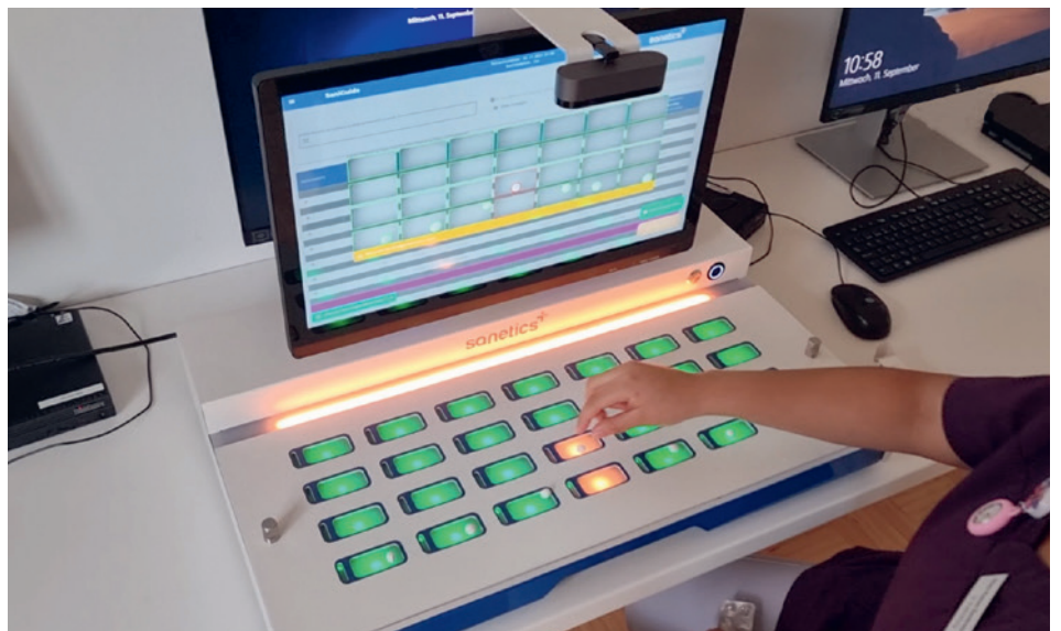
Die SaniGuide Richtstation führt die Mitarbeitenden durch den Richtprozess und schliesst durch eine automatische Prüfung Richtfehler aus.
